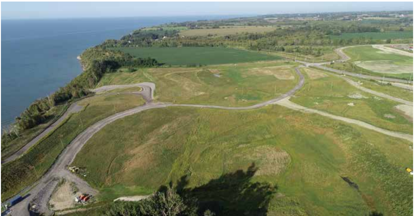
Installation de gestion des déchets à long terme de Port Granby – Plus de 1,3 million de tonnes de déchets excavés des rives du lac Ontario dans le sud-est de Clarington sont maintenant stockées en toute sécurité dans le monticule de stockage en surface, qui a été recouvert et fermé à l'automne 2021.
